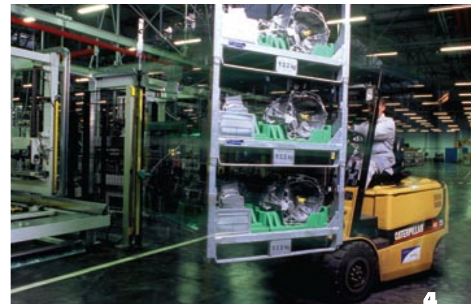
4. A diferencia de otros métodos de manipulación fijos en la línea, una carretilla elevadora puede ir casi a cualquier sitio, una característica útil en muchos entornos de producción. (Imagen cortesía de PSA).
